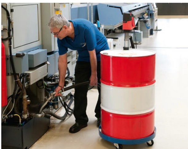
Заправка системы гидравлическим маслом (модель F 430 AL).
