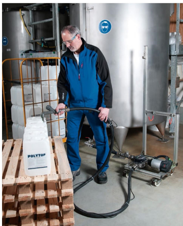
Перекачка чистящего средства из высокого резервуара в канистры.
