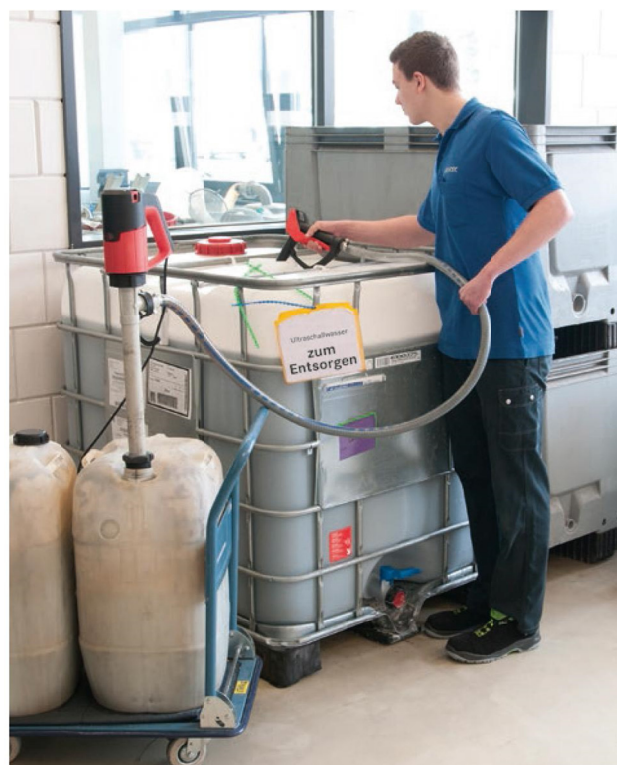
Перекачка отработанных химических веществ (модель F 424 PP).
