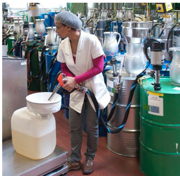
Перекачка эфирного масла (модель F 430 S).
