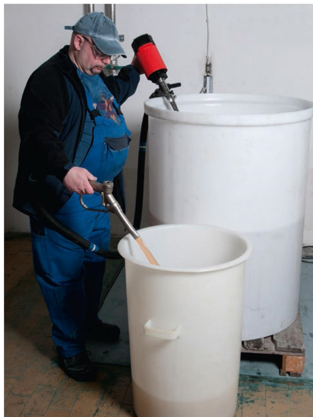
Включение режима перекачки осуществляется простым поворотом рукоятки
