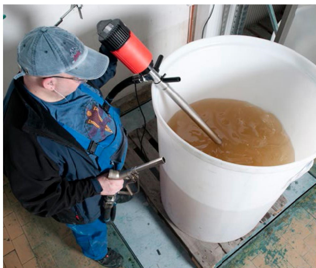
Использование насоса F 426 для перемешивания среды перед перекачкой.
